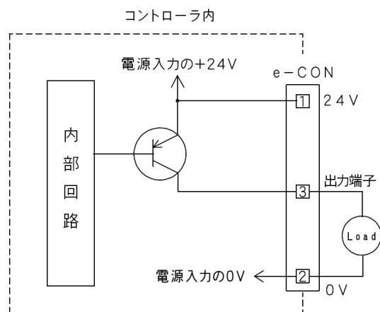
本出力素子は、負荷短絡もしくは定格以上の電流が流れた場合は、内部回路が破損します。リレー等の誘導負荷を接続される場合は、リレーの負荷電流をご確認の上ご使用下さい。また、コイルに逆起電力吸収用ダイオードを必ず接続して下さい。
